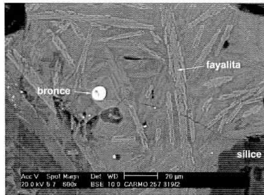
Fig. 15. Imagen obtenida en el microscopio electrónico de barrido (electrones retrodispersados) de la escoria de Carmona (Sevilla). Detalle de una formación de cristales de fayalita.
