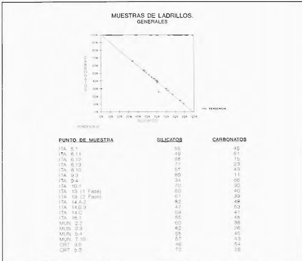
Figura 5.- Gráfico representativo de los componentes de los ladrillos analizados en edificios de Itálica, Munigua, Carteia y Belo.
